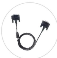
Przewód DB26-DB26 łączy dwa przemienniki w celu realizacji funkcji rezerwowej
